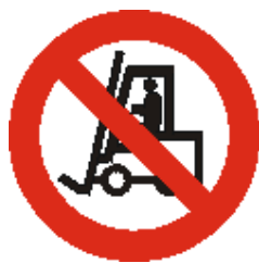
Vietato ai carrelli di movimentazione
